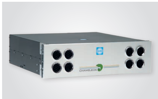
3 HU sous rack 19" avec un switch GigE incorporé Montage jusqu'à 10 modules CHAMELEON Alimentation et ventilateurs intégrés, redondance d'alim en option
